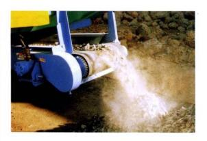
Il modello MC140P si basa sulla nostra tecnologia usata per la serie di semoventi NC. MC140P è equipaggiato con la piastra di carico mobile e il frantoio a mascelle AC sul carro. La migliore soluzione di frantoio a mascelle per lavori di demolizione in spazi ristretti.
